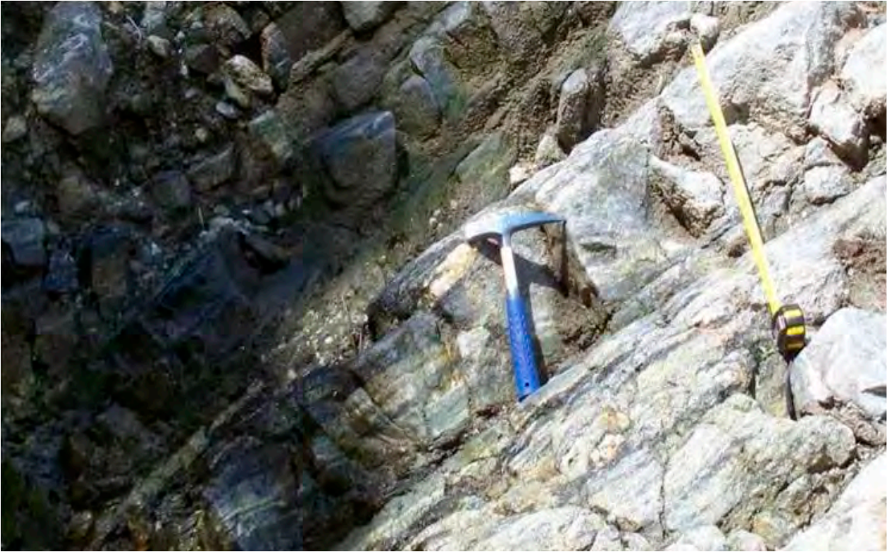
Fig. 4.3. Gneises en las vertientes del torrente San Jaime exhibiendo cuatro familias de discontinuidades con espaciado de pocos centímetros.
