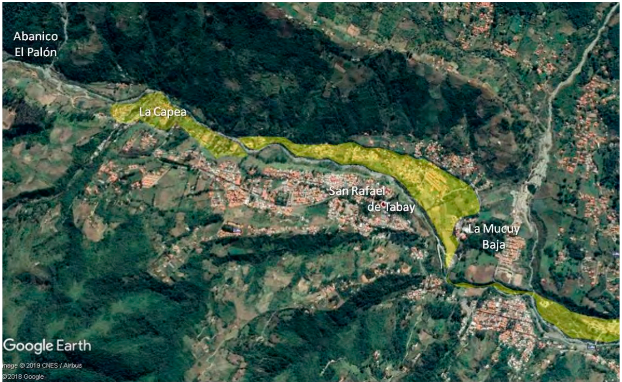
Fig. 4.21. Imagen de satélite en la que se observan algunas comunidades asentadas aguas abajo del abanico El Palón. Resaltado en amarillo se encuentran los sectores más susceptibles de ser impactados por una ola de descarga. IMAGEN TOMADA DE GOOGLE EARTH, 2018
