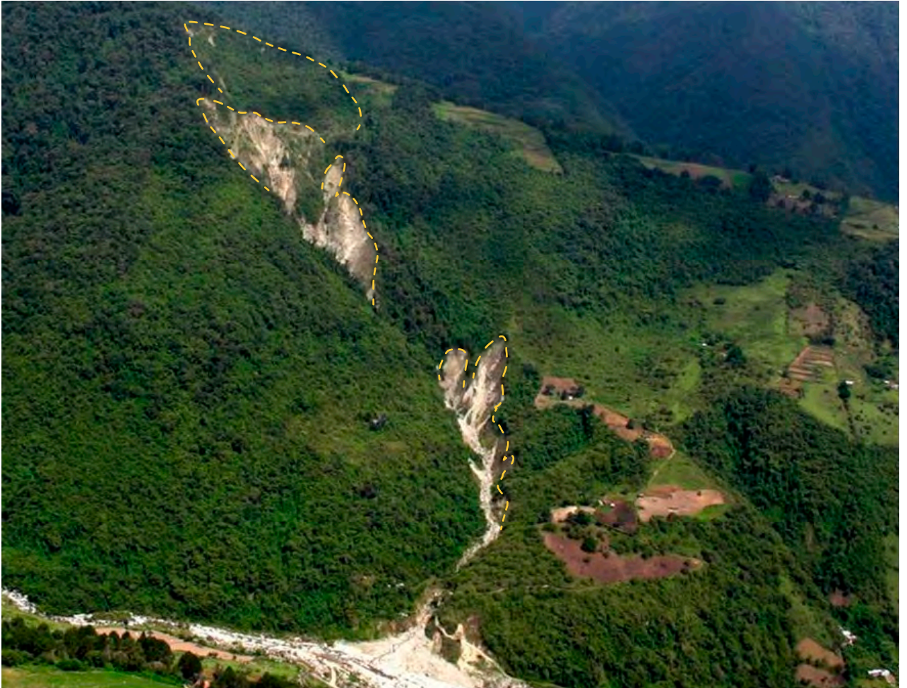
Fig. 4.1. Abanico El Palón, al noreste de Tabay, estado Mérida, Venezuela. Obsérvese las coronas de deslizamientos rotacionales y zonas de caídas de rocas que aportan materiales que promueven la formación de flujos de detritos.
